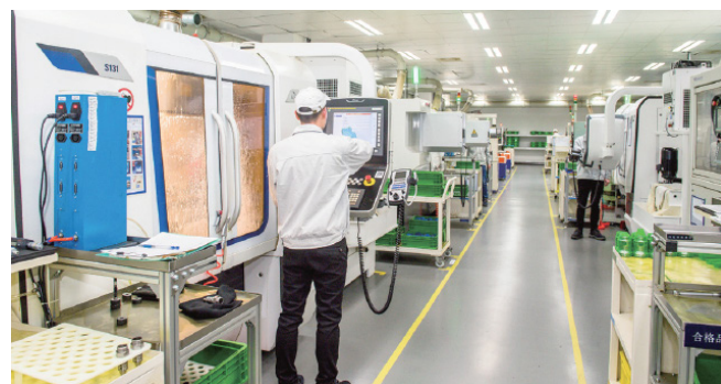
恒立液压研发的新产品——重载轴向柱塞变量泵V30G系列精密零件磨削加工
