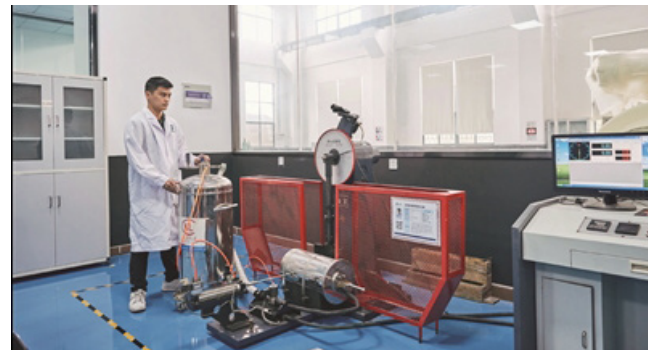
工作人员在进行材料低温冲击试验 ■
